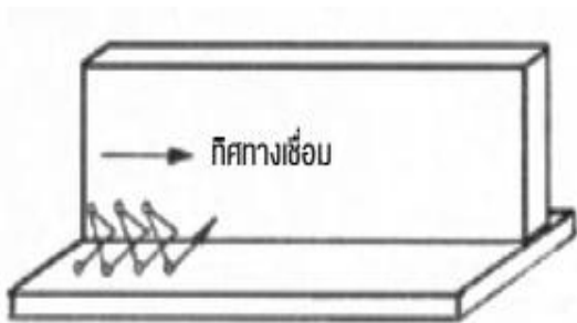
รูปที่ 13: แนวสายของลวดเชื่อมขณะเชื่อมพอกเข้ามุม
