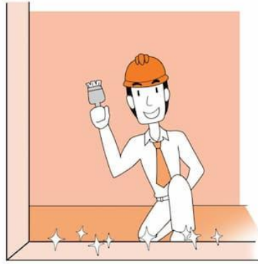
ทำความสะอาดบริเวณที่จะก่ออิฐมวลเบาให้สะอาด
